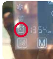
**IMPORTANTE: COMPRUEBE QUE NO EXISTE PROGRAMADO INTERVALOS DE TIEMPO NO DESEADOS**, de modo que la bomba de calor deje de funcionar de forma involuntaria. En ocasiones puede venir programadas con algún intervalo de fábrica, dado que se prueban las unidades.
